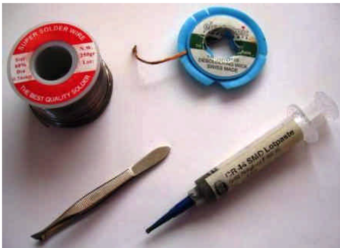
Abbildung 5: Hilfsmittel zum Arbeiten mit SMD-Technologie
